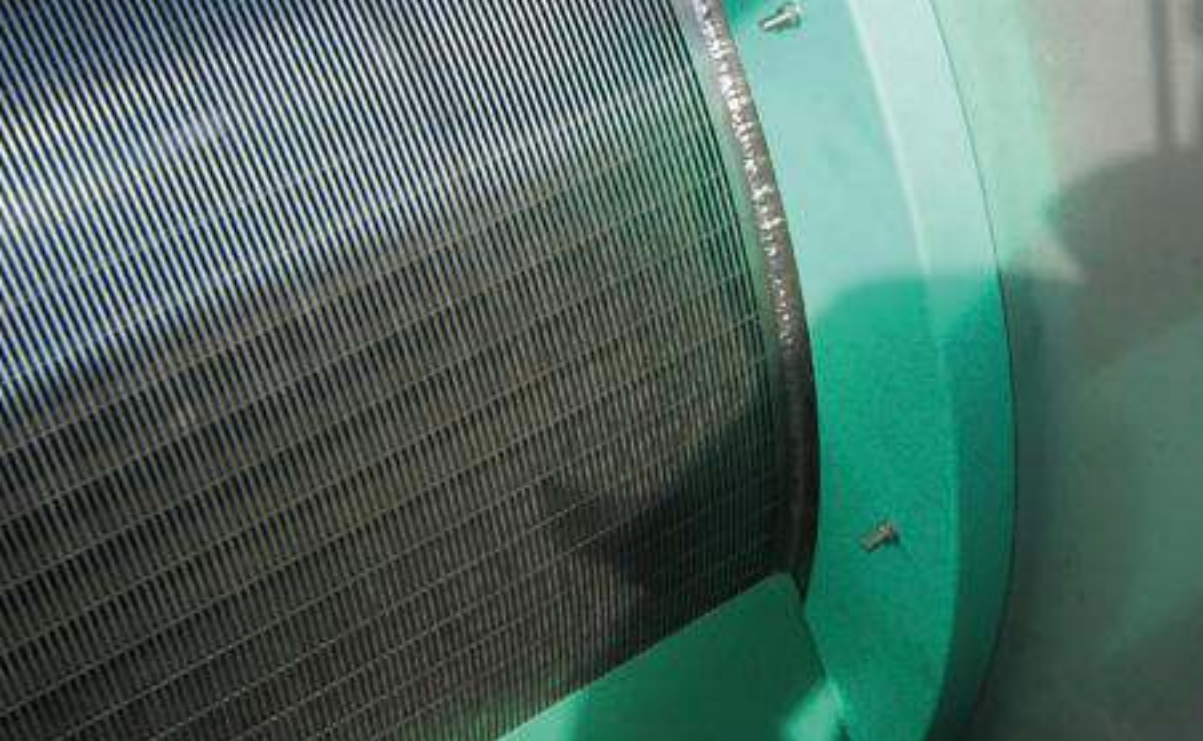
05-0352 Dettaglio tamburo filtrante a barre trapezoidale.
