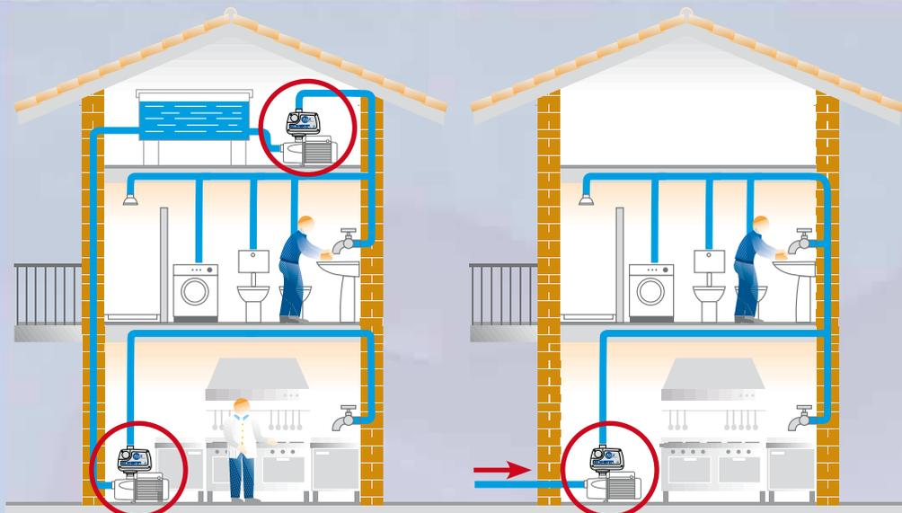
■ Installazioni con pompa alimentata da serbatoio di accumulo sopraelevato.
