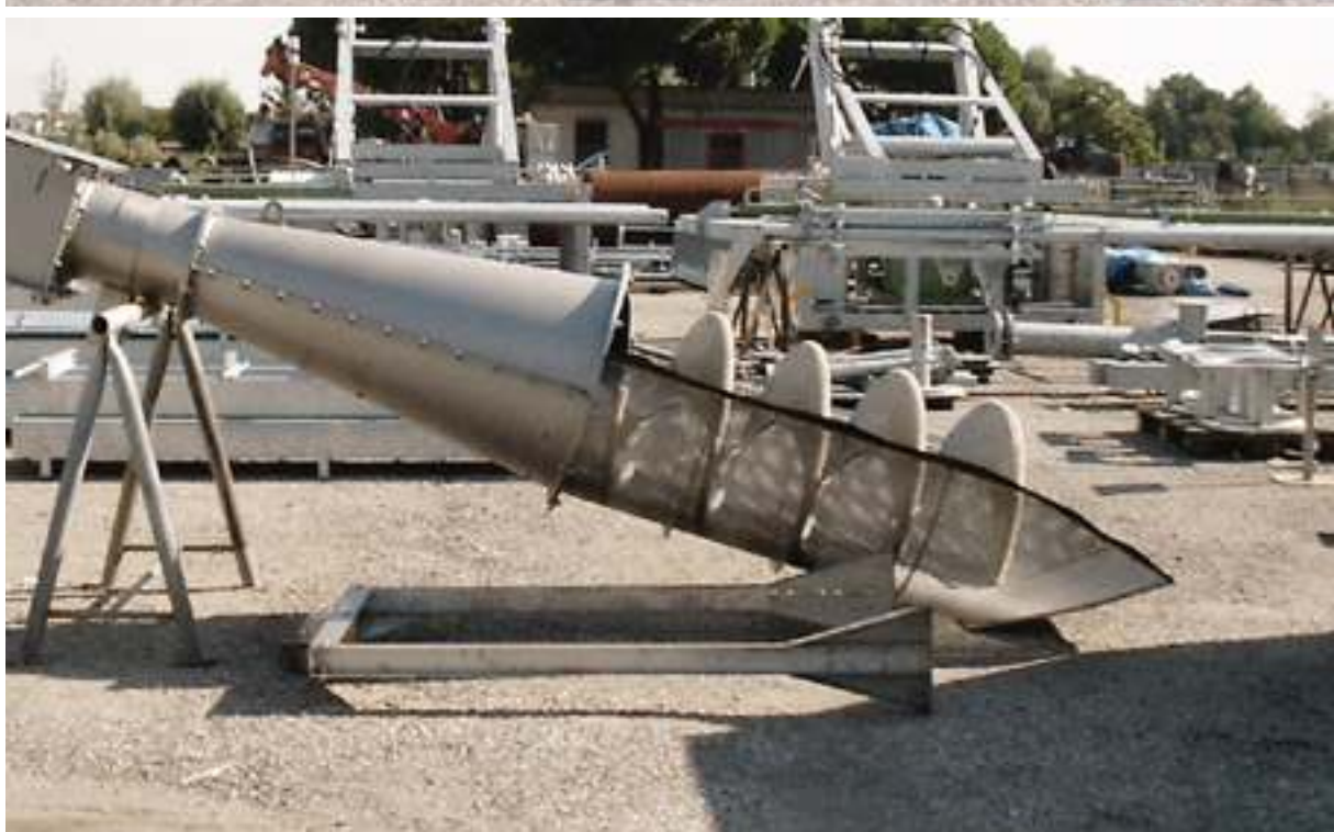
05-0362 Vaglio e zona conica. Basket with conical zone.
