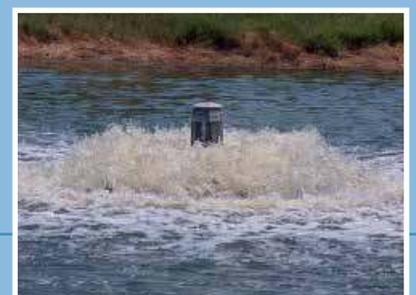
Aeratore di superficie tipo AGV installato in lago artificiale
